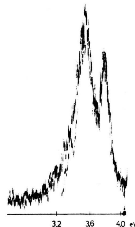
Abb. 1. Energieverlustspektrum einer 600 Å dicken Silberfolie zwischen 2,5 und 4 eV bei T = 7 °K. Der linke Verlust stellt den Oberflächen-, der rechte den Volumenverlust dar.
